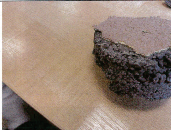
Selgus, et selles mõranenud ja ka hiljem silikooniga „remonditud“ piirkonnas ei ole üldse armeeringvõrguga kihti
