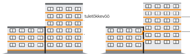
Joonis 3.2.29. Aknad samal kõrgusel Joonis 3.2.30. Hooneosade aknad eri kõrgusel
