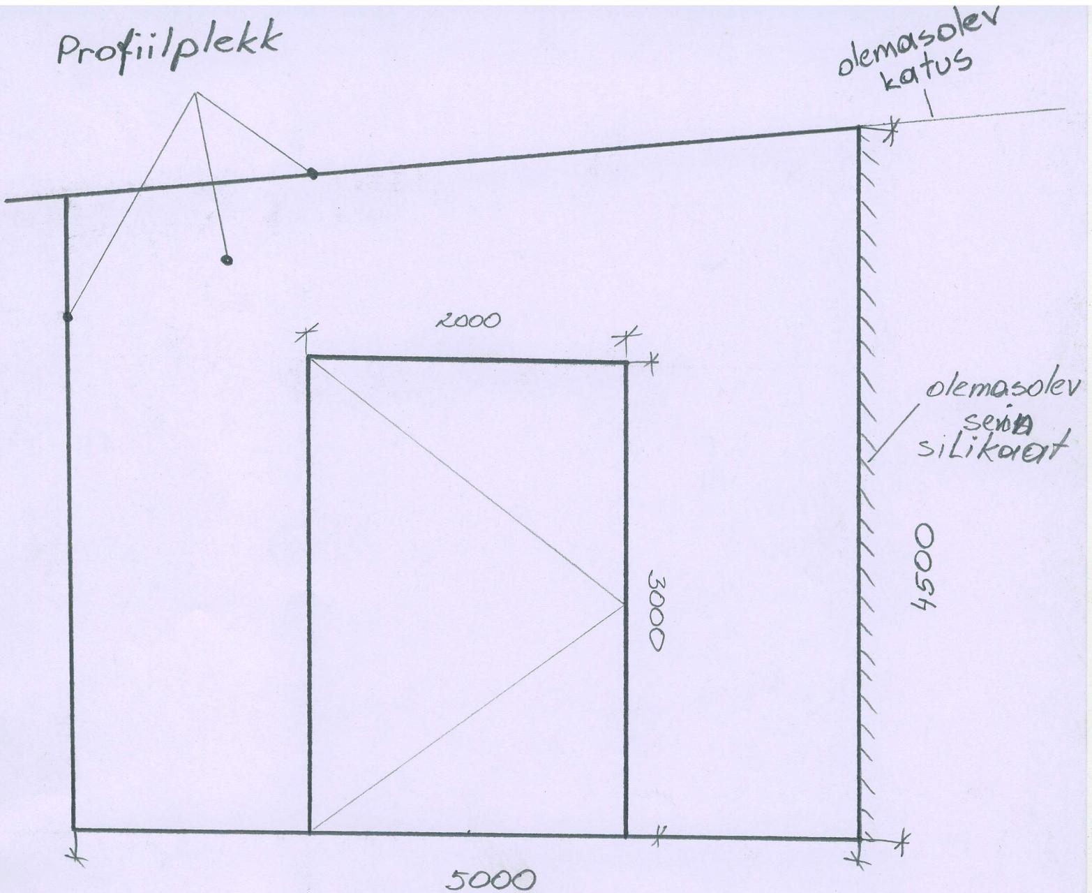
See on otsa vaade! Hoone pikkus on 24,5 m. Kaetud profiilplekiga. Valmistatud siis kas metall või puit konstruktsioonile. Mõlemad otsad on identsed peegelpildis – st. uksed mõlemas otsas. Pinnaseks momendil liiv-muld-killustik. Oleks vaja ka pinnas teha tõstukiga sõidetavaks. Pakkuda võib erinevaid lahendusi.
