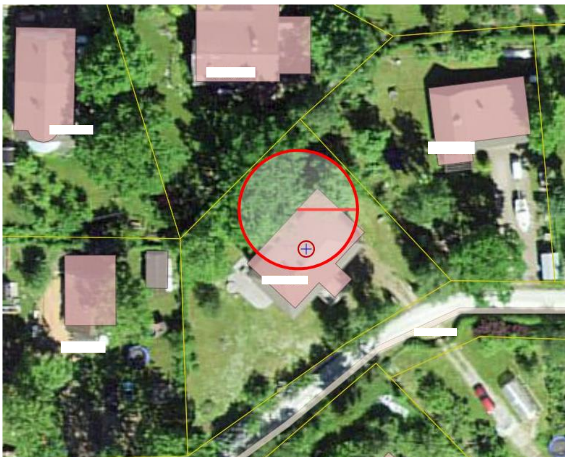
Joonis 2 Soojuspumba mõjuraadius 10m.
