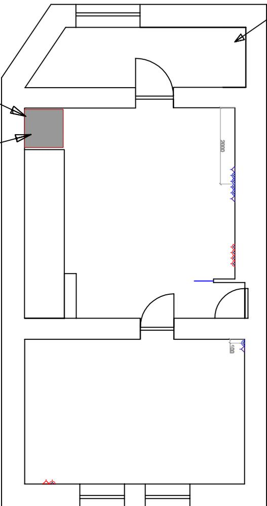
Компьютерный шкаф компьютерной и телефонной сети; интернетные и телефонные входы и провода компьютерной и телефонной сети провести в это место, оставив свободные концы длиной 2 метра.
